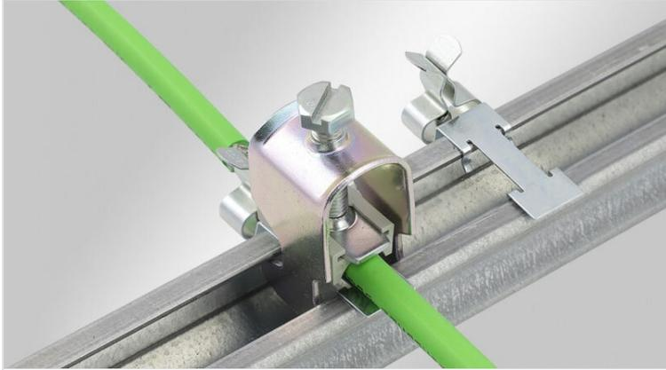
使用EMC屏蔽夹，其中电缆的屏蔽层必须连接到地电位。它们易于使用，可有效地将单根电缆屏蔽层接地。
